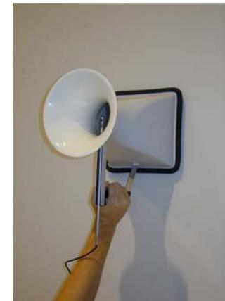
Mesure de débits au bouches par cône de mesures et anémomètre
